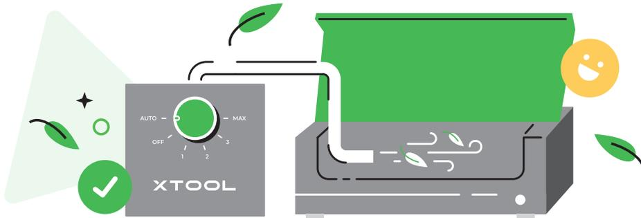
에어 어시스트 세트는 공기를 빨아들인 후 에어 튜브를 통해 레이저 기계에 주입합니다. 공기 유량은 조절할 수 있습니다. 일반적으로 낮은 공기 유량은 레이저 각인 과정에서 가공 영역을 청소하고 가공된 소재 부분을 냉각시키는 데 사용되며, 높은 공기 유량은 레이저 절단 시 청소 및 냉각뿐만 아니라 연기 배출 및 찌꺼기 제거에도 사용됩니다.
